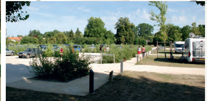
A Sansais (à gauche), Coulon (à droite) et Arçais (en haut), ces parkings ont été aménagés avec la prise en compte des affluences estivales. En alternative à l'enrobé, un revêtement calcaire couvre une aire de stationnement permanente. Un parking annexe, fait d'un mélange terre-pierre perméable, offre l'aspect d'une prairie et est seulement ouvert l'été. Ces espaces permettent aussi d'accueillir d'autres usages de loisirs et de détente tout au long de l'année (conception : Mutabilis, paysagistes, Paris / CG79).
