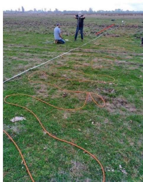
Figure 19b : Extrait du grand dispositif d'acquisition de la TRE_1m_Z3. Au premier plan : zone sans mottureaux dans le chenal. A l'arrière-plan (trait rouge) : zone de petits mottureaux dans le chenal.
