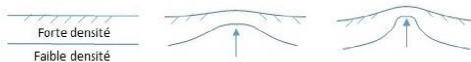
Figure 33a : Schéma de principe du micro-diapirisme. Par analogie avec le diapirisme observé à une plus grande échelle, ce phénomène provoquerait la remontée de sols très légers à travers un sol déformable plus dense.
