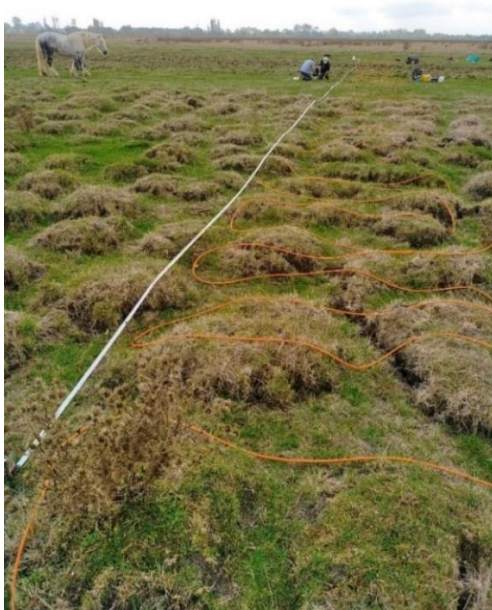
Figure 19a : Extrait du grand dispositif d'acquisition de la TRE_1m_Z3 (extrémité Nord dans la zone de mottureaux en périphérie du chenal).
