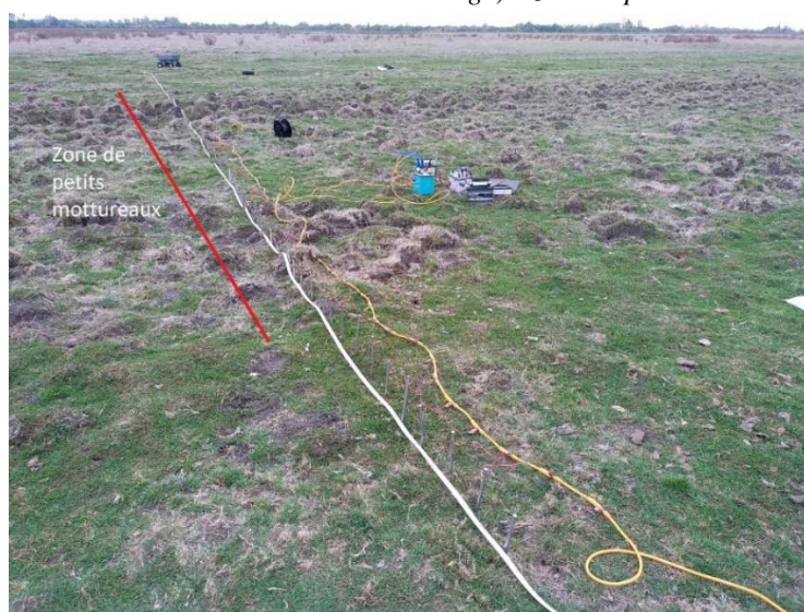
Figure 19c : Petit dispositif d'acquisition de la TRE_0,2m_Z3 (distance inter-électrodes de 20 cm). Au premier plan : zone sans mottureaux dans le chenal. Au second plan (trait rouge) : zone de petits mottureaux dans le chenal.
