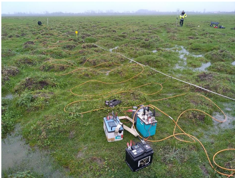
Figure 6. Dispositif d'acquisition de Tomographie de Résistivité Electrique (TRE) à 48 électrodes utilisé dans l'étude. Il est ici mis en place avant l'aplatissement des mottureaux le 26 janvier 2023.
