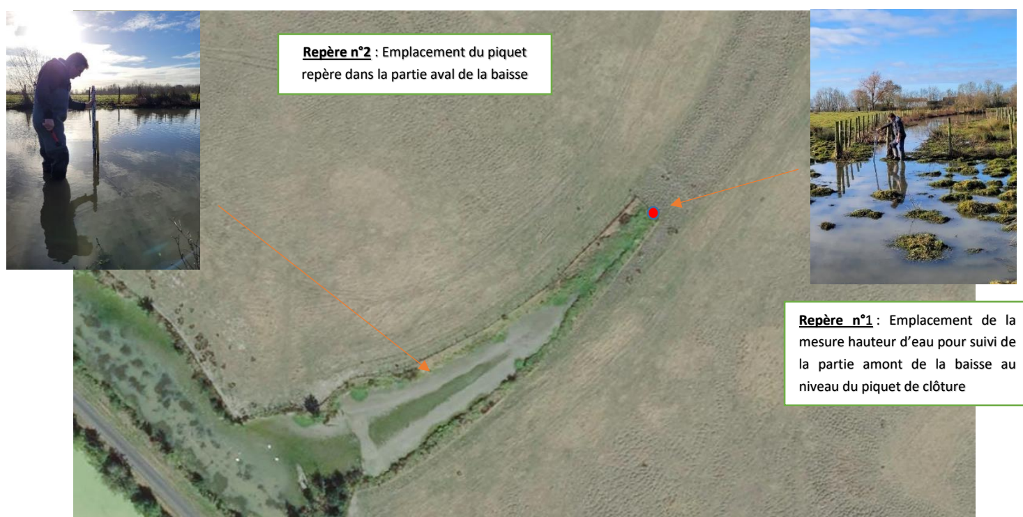
Figure 4 : Localisation des points de suivi des niveaux d'eau en 2022
