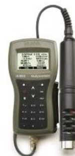
Photographie 11 Sonde multi-paramètres HI 7609829 (Hanna Instrument®)
