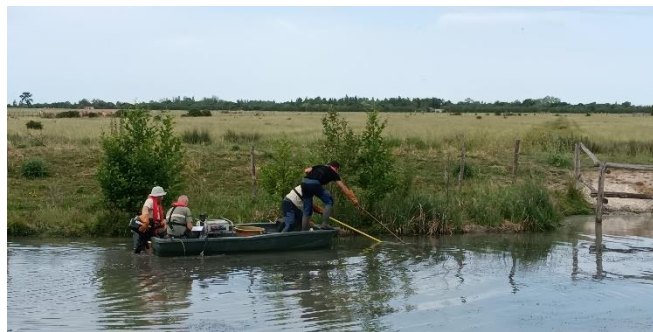
Photographie 2 : Aperçu de la pêche électrique réalisée sur le Fossé Ouest du marais communal du Poiré-sur-Velluire le 18/05/22. Le matériel de pêche électrique EL 63 IIF se trouve au centre du bateau. Les opérateurs soumettent les poissons au champ électrique à l'aide de l'anode mobile et récupèrent le poisson à l'aide d'une épuisette.
