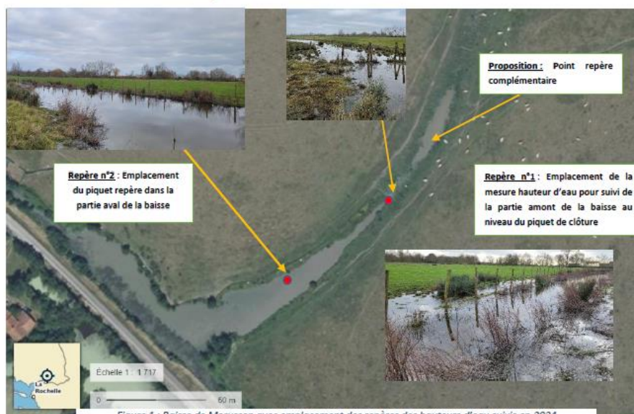
Figure 1 : Baisse de Morusson avec emplacement des repères des hauteurs d'eau suivis en 2024
