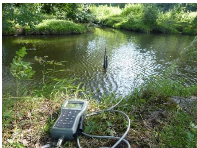
Figure 3. Relevé des paramètres physico-chimiques de l'eau avec un instrument multiparamètres Hanna.
