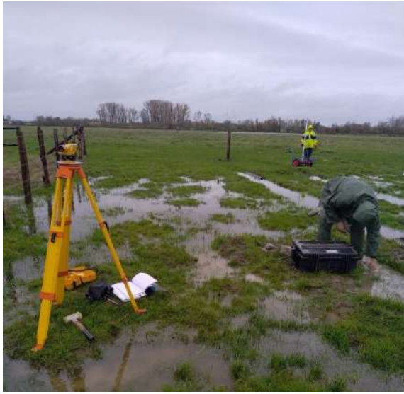
Figure 3a. Au premier plan à gauche : le niveau optique sur trépied. Au second plan à droite : la mire tenue verticalement.
