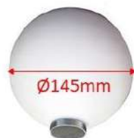
Figure 6a. Trois sphères fixes sont utilisées pour chaque point de scan afin de permettre l'assemblage des différents nuages de points acquis.
