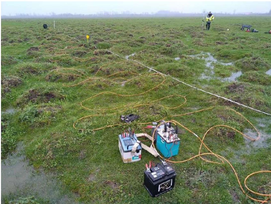
Figure 5. Dispositif d'acquisition de Tomographie de Résistivité Electrique (TRE) à 48 électrodes utilisé dans l'étude. Il est ici mis en place avant l'aplatissement des mottureaux le 26 janvier 2023.
